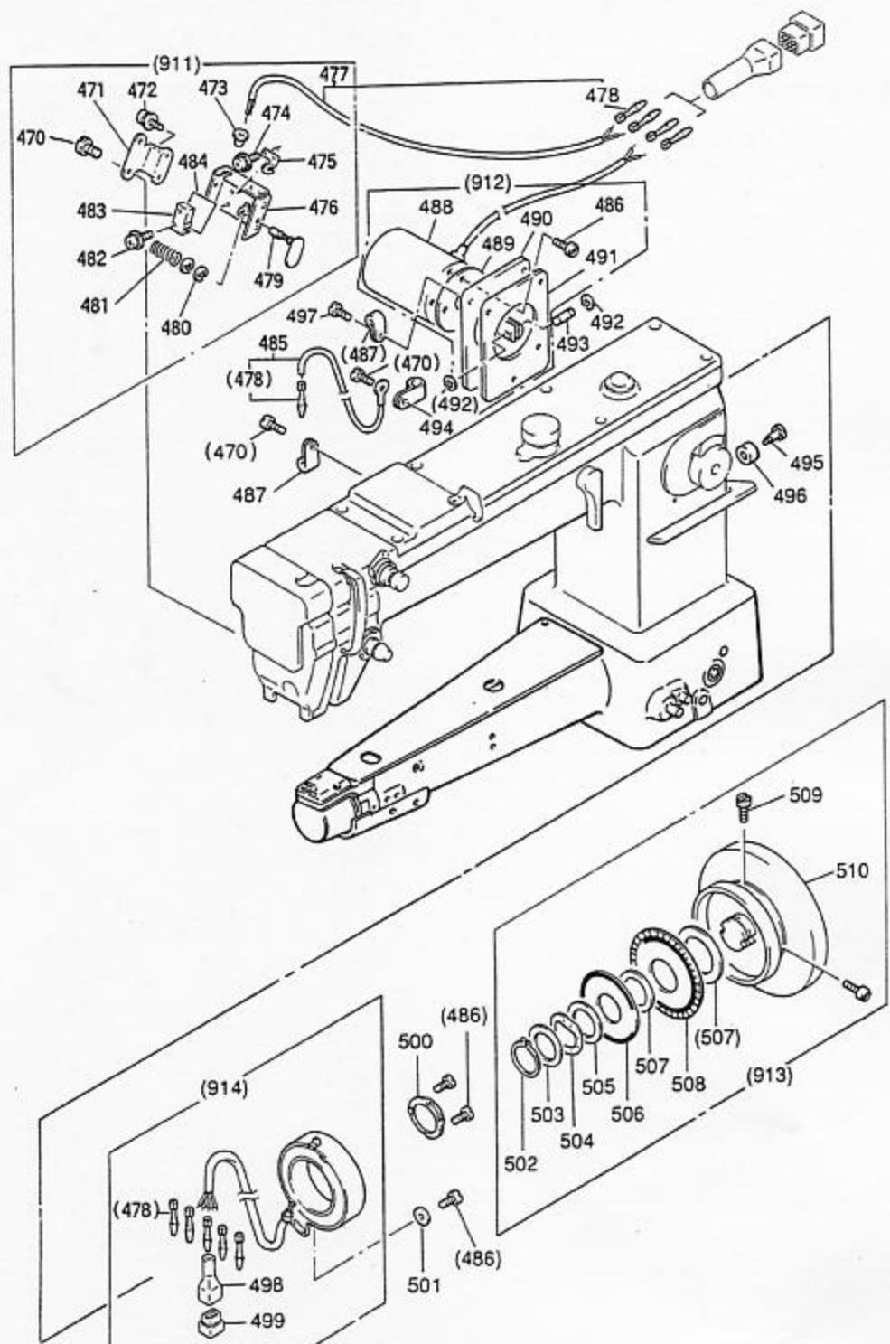
M タッチバック機構および検出器機構
